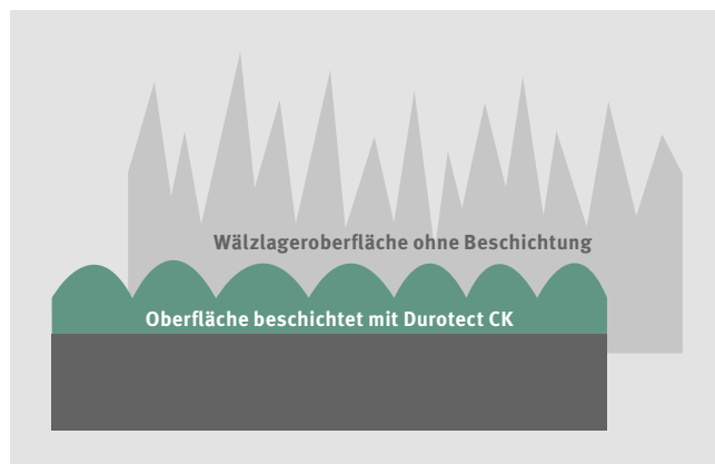
Strukturfrage: Mit Durotect CK beschichtete Oberflächen sind verschleißfester und wirken reibungssenkend
