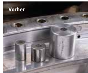
Rollen und Laufbahn mit Korrosionsspuren und Fremdkörpereindrücken
