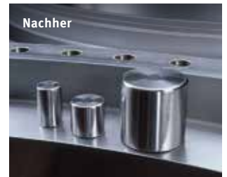
Nachgeschliffene Laufbahn, neue Rollen mit angepasstem Übermaß
