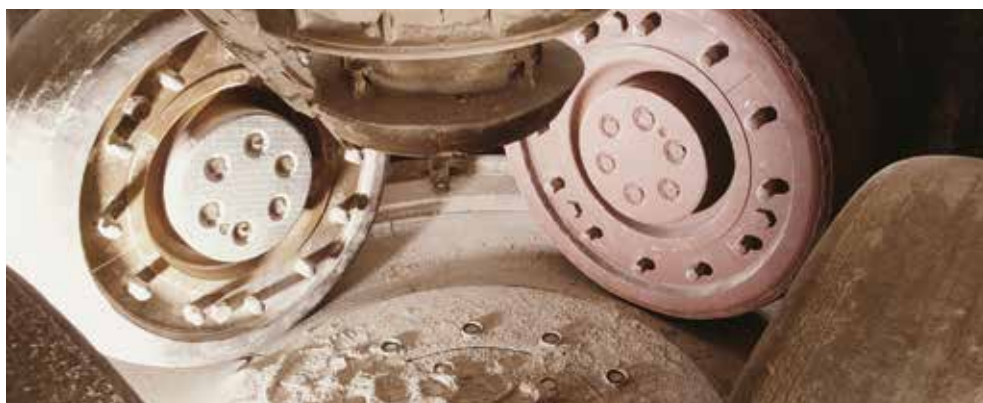
Mahlwalzen einer Vertikalmühle (Zementverarbeitung)
