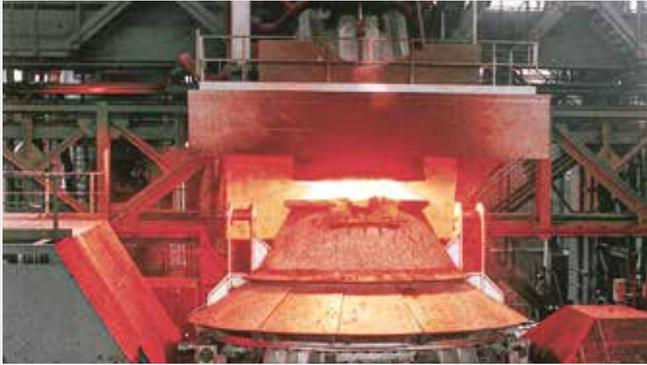
Um die Kapazitäten seines Oxygenstahlwerks zu erhöhen, plante ein führender europäischer Stahlhersteller, einen Konverter zu ersetzen. Damit Montage und spätere Wartung rasch erfolgen konnten, entschied sich der Kunde für geteilte Schaeffler-Pendelrollenlager und maßgeschneiderte Sphärogussgehäuse, welche auch für den Einsatz geteilter Pendelrollenlager konzipiert sind. Beides reduzierte die Montagezeiten erheblich. Das Ergebnis sind dauerhaft gesenkte Wartungs- und Stillstandskosten.
