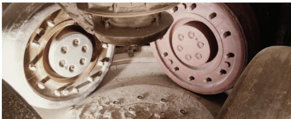
Mahlwalzen einer Vertikalmühle (Zementverarbeitung)
