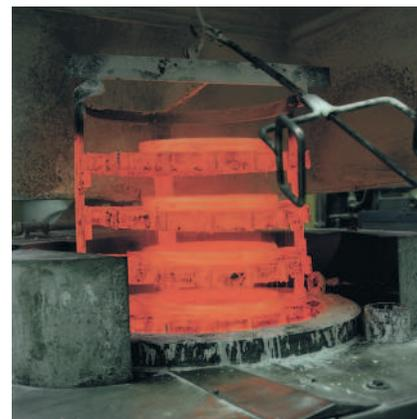
Erhöhung der Verschleiß- und Dauerfestigkeit durch Einsatzhärten
